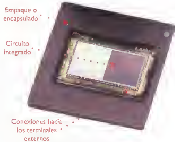
Figura 13.2. Estructura general de un circuito integrado
